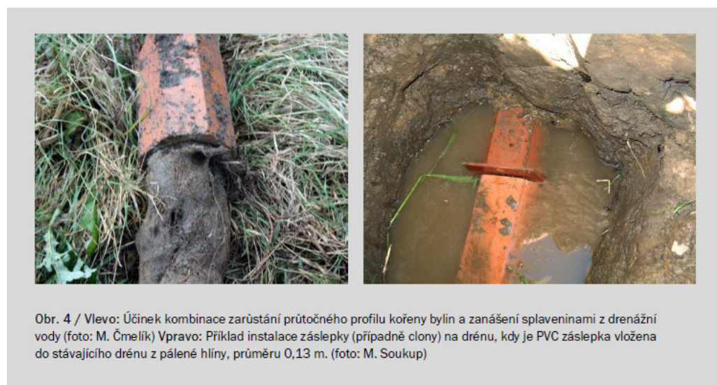
Obr. Příklad přerušení drenážního prvku pomocí kořenů bylin a zanesením splavenin a za pomoci PVC záslepky.
